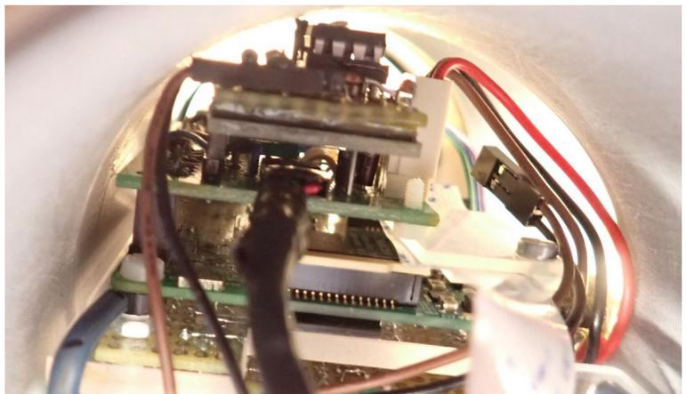
Camera-Modul mit Steuerblock verbinden
